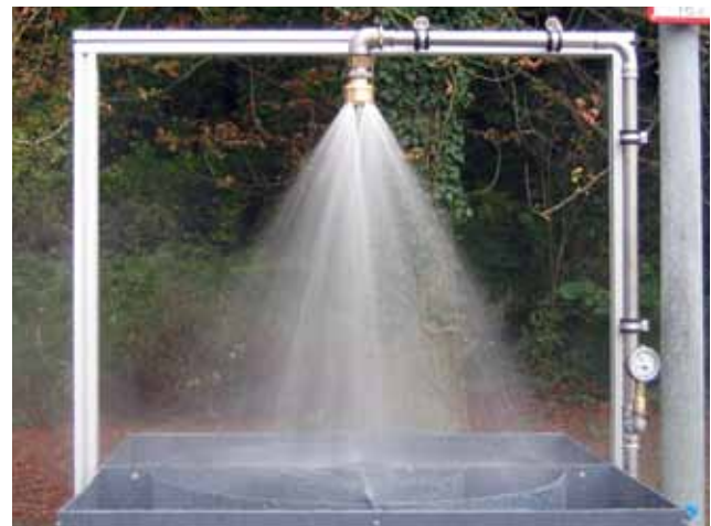
Dosage d'eau conforme à la norme de la pomme de douche d'urgence NovaLab
